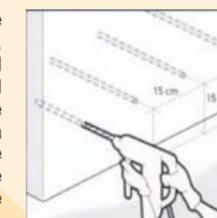
A mayor espesor del muro, se requerirá menor ángulo. La longitud del taladro debe ser 5 cm. menor del espesor del muro. Posteriormente se deben eliminar los restos sueltos y el polvo del interior de las perforaciones.
