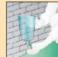
**Inyección por gravedad:** Coloque los inyectores o recipientes de alimentación adecuados, o cartuchos en la boca del taladro. Rellene los recipientes varias veces hasta la completa saturación del soporte.
